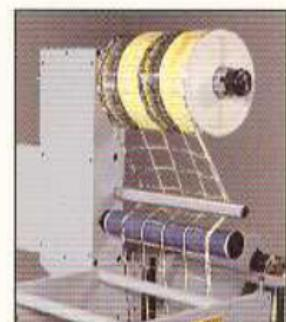
**雙筒回卷：**40英寸單筒回卷是標準配備，也可選購40英寸與40英寸的雙筒回卷裝置。
