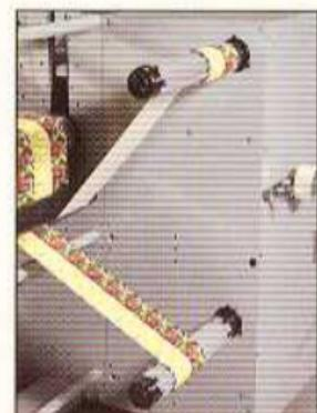
**金屬護板：**機器後方背體是用我們特別設計而不需工具即可拆卸的金屬板封閉，堅固實用，容易保養又便於維修。
