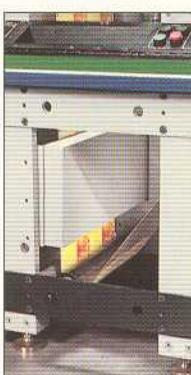
**乾燥:** 每一印刷機組都有單獨的高速空氣幕式系統，提供高效乾燥。當使用UV墨印刷或上光時，每一機組還可加裝UV乾燥裝置。
