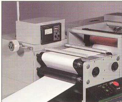
**張力控制:** 為控制卷筒紙，我們用負載電池裝置測量張力。當卷筒紙轉過其表面時，即得出測量數據。這些數據，經電腦處理傳給制動裝置。細微的張力變化使制動裝置連續不斷地控制紙卷的平穩運轉，保證了印刷的高質量。
