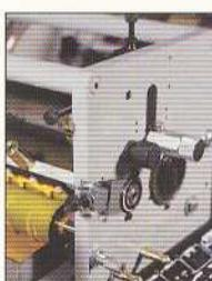
**機身:** 1英寸厚整塊金屬板製造的機身，確保機器穩定精確地運轉。
