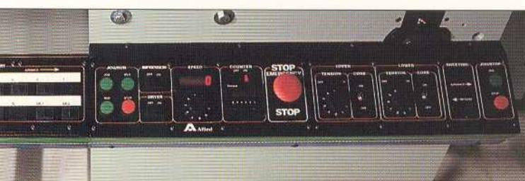
計的。我們把所有的控制鈕設計成一個現代化的總控制盤。控制所有印刷機組的套印，運轉控制，回卷控制和分切控制。精心設計大的功能。
